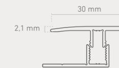
Para utilizar cuando quieras rematar tu instalación sin apenas resalte. Muy útil en el caso de acabar contra un ventanal o contra zócalos de muebles o piezas de baño.
